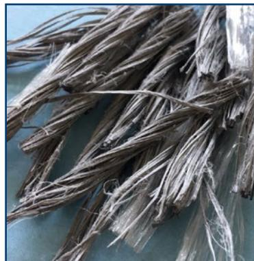
FIBERTEK PMR è una macrofibra pluri-filamento composta da materiali polimerici ad elevata densità e resistenza.
