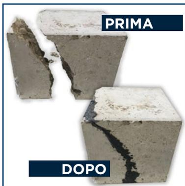
Prodotto bicomponente a base di resine epossidiche formulato con particolari cariche e agenti tixotropici, impiegato come adesivo e stucco per realizzare incollaggi strutturali e riparazioni.
