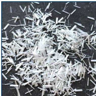
FIBERTEK PVA è una fibra sintetica appositamente studiata per il rinforzo dei calcestruzzi ad elevate performance, alcali resistente.
