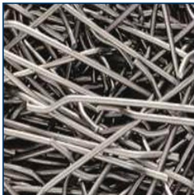
Le fibre FIBERTEK A sono ottenute mediante trafilatura a freddo del filo d'acciaio ad alta resistenza con particolare sagomatura ad uncino alle estremità per ottenere il miglior ancoraggio su tutta la loro lunghezza, per il rinforzo strutturale. Le caratteristiche del filo di acciaio da cui sono ricavate le fibre FIBERTEK A soddisfano le normative di riferimento relative al tipo di impiego e possono essere fornite anche nel tipo zincato.
