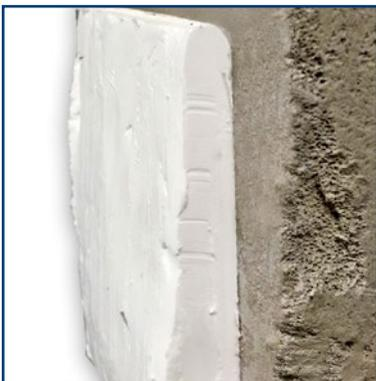
Intonaco mono-componente leggerissimo, non espandente, a base di un compound di resine sintetiche e cariche amorfe di granulometria finissima, la cui conducibilità termica risulta bassissima. L'impasto è pronto all'uso, di facile lavorabilità per applicazioni sia su superfici orizzontali che verticali. Può essere tranquillamente applicato sia a spatola che a spruzzo.
