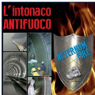
Speciale intonaco premiscelato antifuoco studiato appositamente per resistere alle alte temperature. Garantisce l'efficacia e la continuità della massima protezione dal fuoco come richiesto in caso d'incendio. Impiegato per il trattamento antincendio dei rivestimenti delle gallerie. AETERNUM FIRE è certificato alla resistenza al fuoco secondo la normativa UNI 11076, classificazione T1 e T2.
