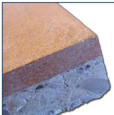
Malta cementizia polimerica a base di speciali resine sintetiche modificate.
