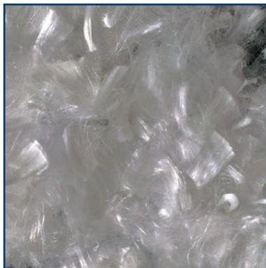
Microfibre in polipropilene vergine monofilamento. Incorporate alla matrice cementizia (calcestruzzo, malta, ecc....) al fine di costituire un materiale omogeneo in grado di contrastare il ritiro plastico.
