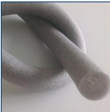
Cordolo in polietilene espanso a cellule chiuse specifico per guarnizioni, sigillature e come isolante. È impermeabile all'acqua, resistente all'umidità ed è apprezzato per la sua resistenza chimica, leggerezza ed elasticità. Il cordolo FILTEK rappresenta la soluzione ideale per i problemi di sigillatura dei pannelli prefabbricati e dei giunti di dilatazione.
