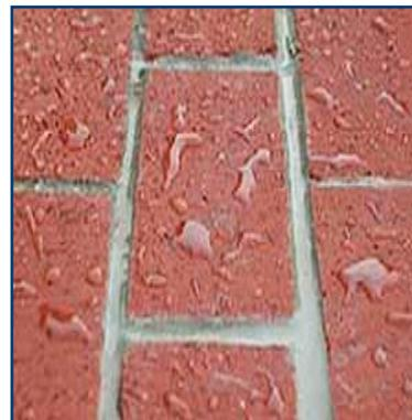
Idrorepellente siliconico concentrato, formulato per l'idrofobizzazione ed il trattamento anti efflorescenze saline.
